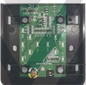
【1】打開內面板上的關門外蓋，(如圖)調節揚聲器音量大小的位置，順時針調節為大音量，逆時針調節為小音量。
