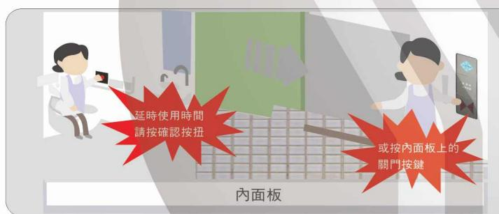
【7】本系統最長使用時間為30分鐘，在使用到25分鐘時，系統會語音提示“本系統將在5分鐘後解除反鎖功能，此時如果繼續使用就按確定按鈕或內面板上的關門按鍵可以繼續使用30分鐘，如果不按則5分鐘後系統自動解鎖。
