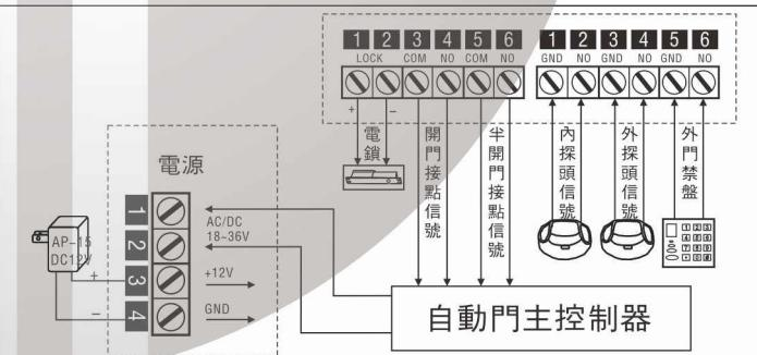
注意：如DC12V電源輸入時須從電源3、4端子接入，不能從1、2端接入，如圖所示。
