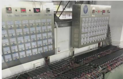
05.电插锁老化测试
