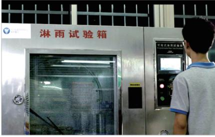
01.防水电插锁雨淋测试设备
