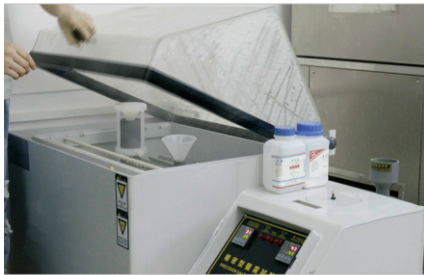
02.电插锁盐雾测试 (确保不同使用环境的耐用度及可靠性)
