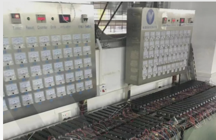
05.电插锁老化测试 (电插锁每把制程1500次测试合格)
