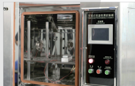
03. 高低温测试 (确保-40℃~60℃恶劣环境应用的可靠性)
