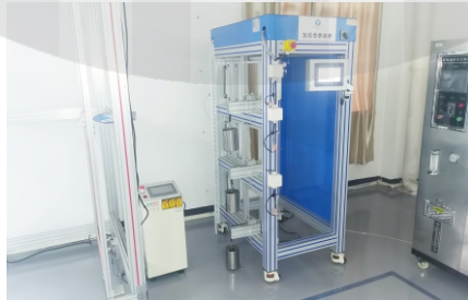
05. 电锁耐用测试设备 (意林180kg磁力锁通过100万次耐用测试)
