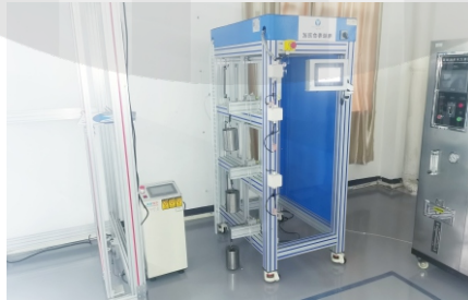
05. 电锁耐用测试设备 (意林280kg磁力锁通过100万次耐用测试)
