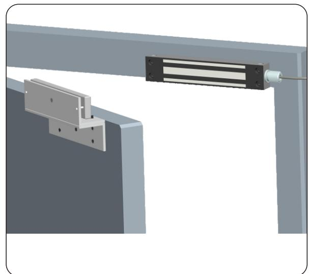
第一步：在Z型支架與吸板之間加入2塊金屬墊片和1塊橡膠墊片。橡膠墊片置于金屬墊片之間。擰緊平頭螺絲，把吸板固定于Z型支架板上。
